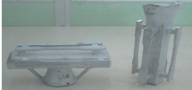
شكل 4: الشجرة بعد عملية الصب وتكسير قالب السيراميك
