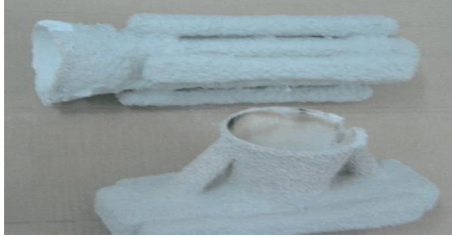
شكل 5: القالب بعد إزالة الشمع
