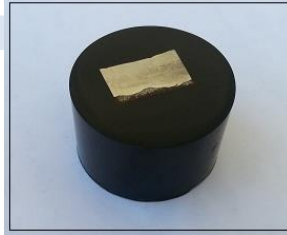
الشكل (1) يوضح العينة داخل القالب.
