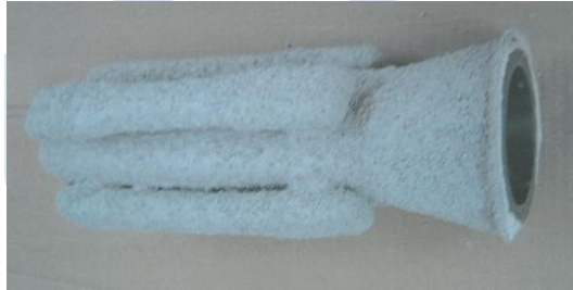
شكل 4 : شجرة الشمع بعد تغليفها بكل الطبقات
