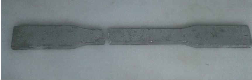
شكل 9: عينة معالجة حراريا بعد إجراء اختبار الشد
