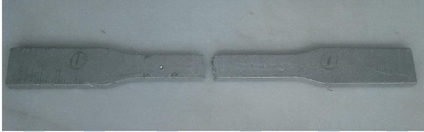
شكل 8: عينة غير معالجة حراريا بعد إجراء اختبار الشد
